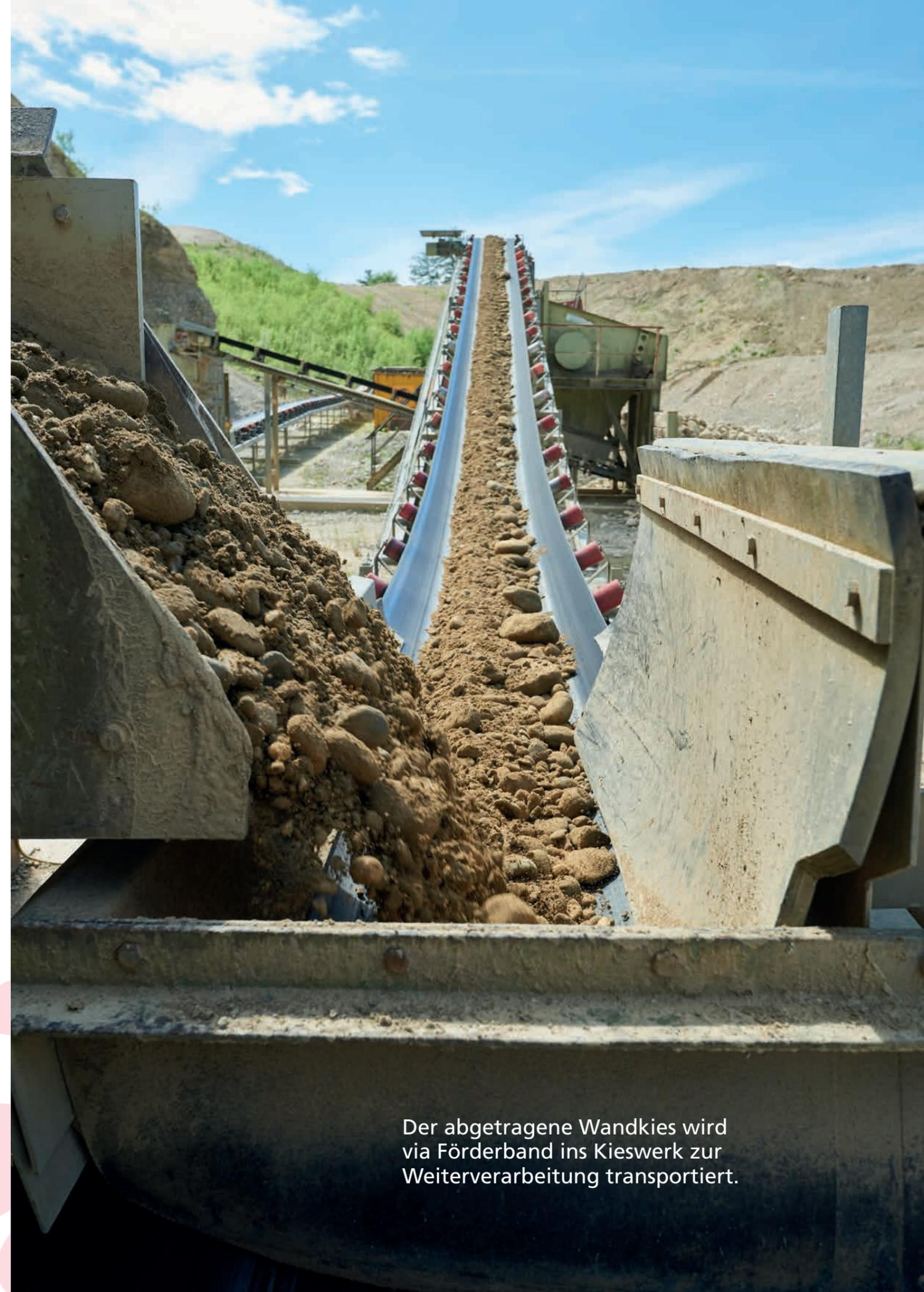
Der abgetragene Wandkies wird via Förderband ins Kieswerk zur Weiterverarbeitung transportiert.
